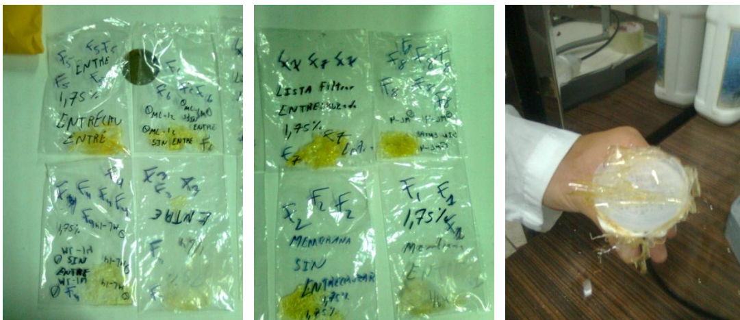
Figura 18. Algunas de las membranas no aptas para filtración.
