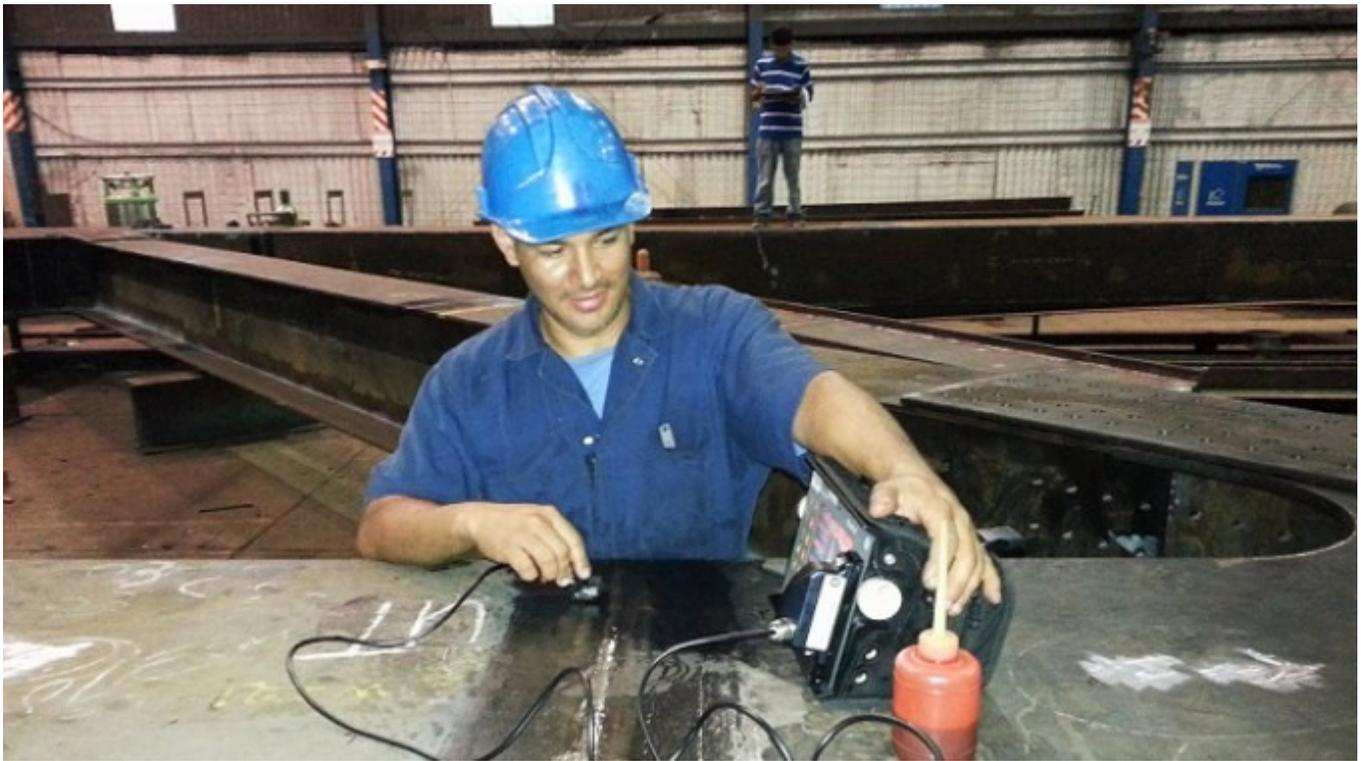
El Ing. Óscar Chaverri ha participado en varios proyectos en los que los ensayos no destructivos se utilizaron para validar la calidad de las piezas metálicas y sus soldaduras. **Foto: Cortesía CIEM-TEC.**
