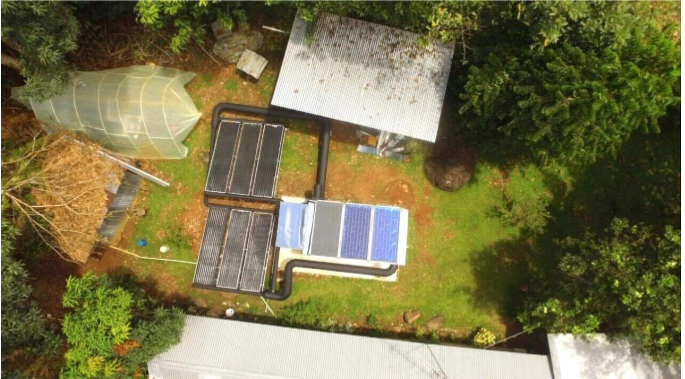
Mediante un sistema mixto se aprovecha la energía solar para el calentamiento de agua a 70° centígrados, para pasteurizar leche y usos de desinfección en una lechería en Santa Rosa de Pocosal, en San Carlos. **Foto: Cortesía T. Guzmán.**
