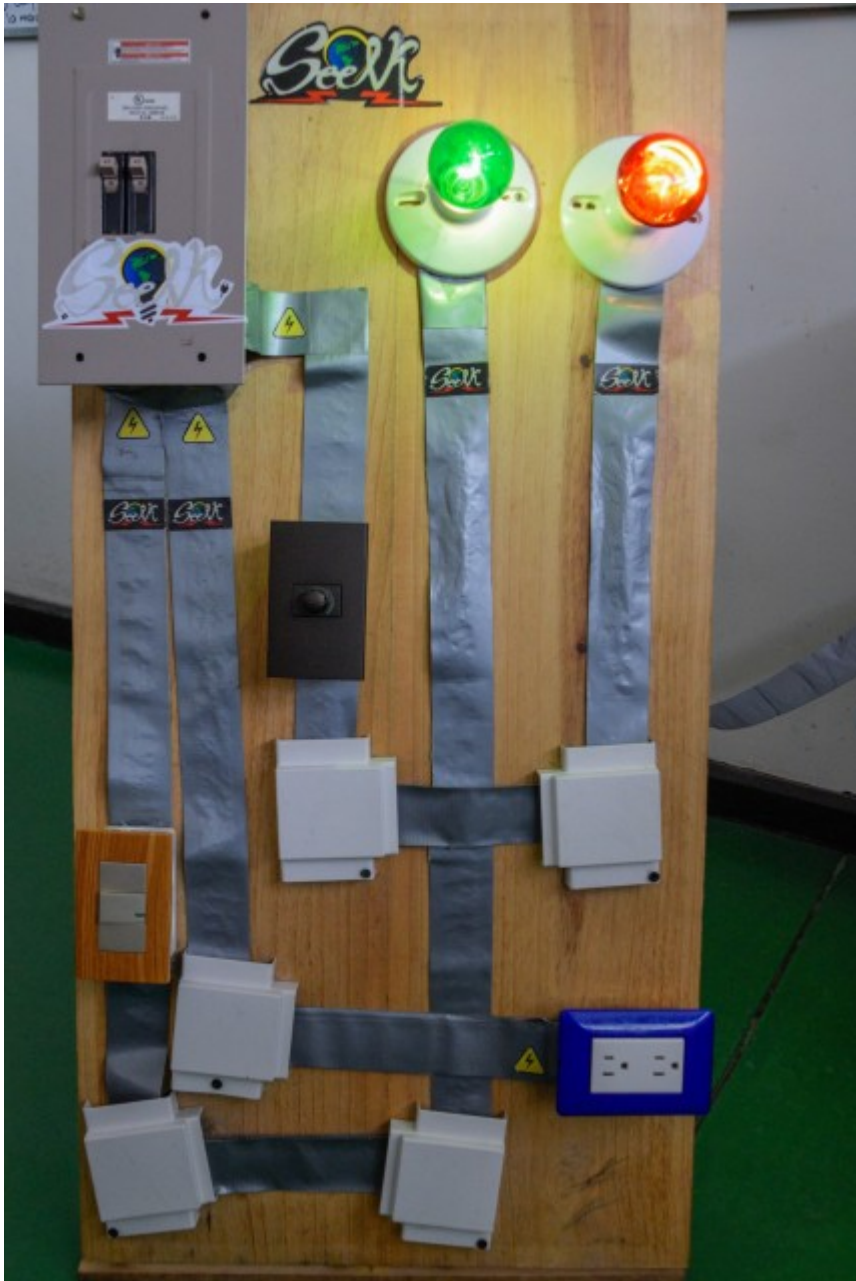
La maqueta que muestra cómo la “Cinta Seelk” reemplaza al cableado. Foto Andrés Zúñiga/ OCM.
