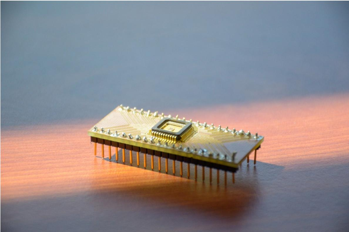
*Imagen del chip electrónico o circuito integrado, diseñado y desarrollado por investigadores del TEC. Se protege con una cápsula de cerámica o de plástico que dispone de interconexiones metálicas que permiten comunicarlos con el mundo exterior por medio de señales eléctricas. Foto: Steven Moya Barrientos /OCM .*
