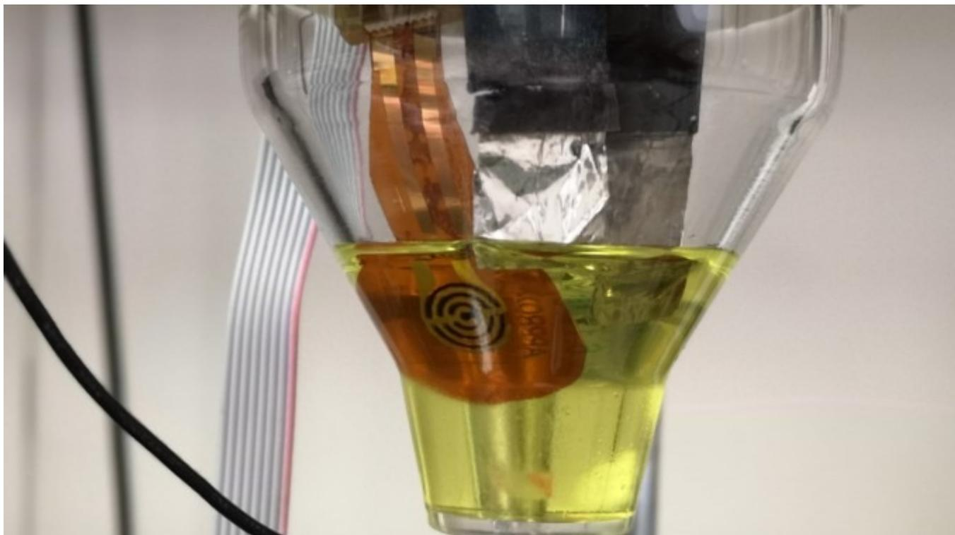
Electrodo flexible de oro modificado para la determinación de plaguicidas en agua.
