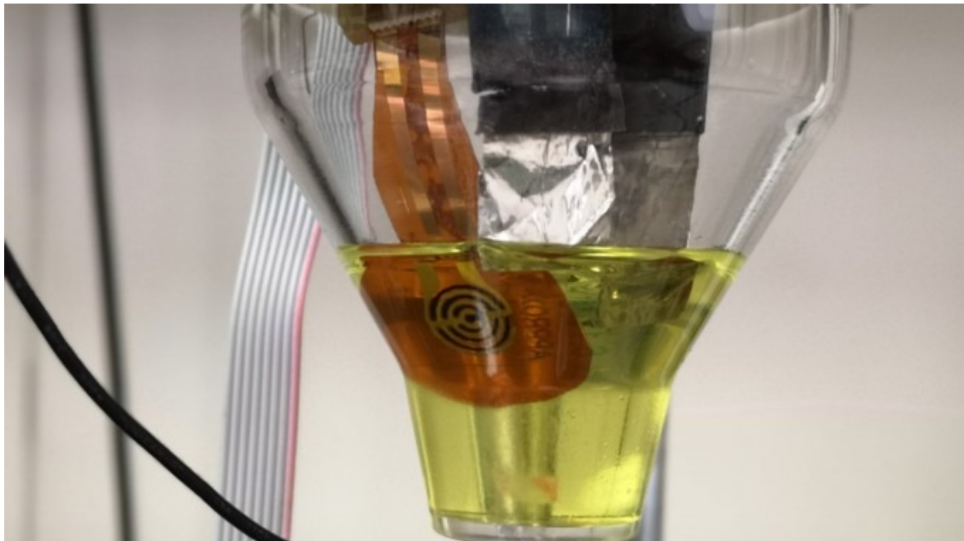
Electrodo flexible de oro modificado para la determinación de plaguicidas en agua. Imagen cortesía de R.Starbird.
