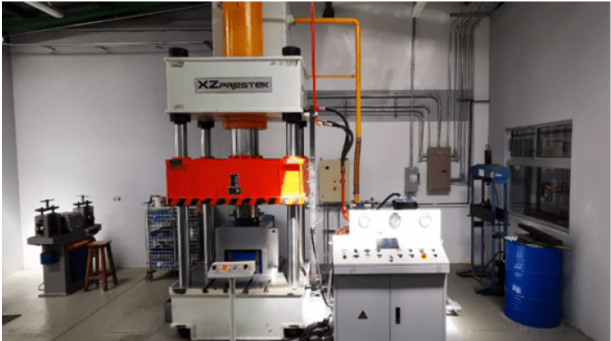
Máquina de torsión de alta presión (HPT) en el Laboratorio de Transformación de Materiales del Centro de Investigación y Extensión en Materiales (Ciemtec) de la Escuela de Ciencia e Ingeniería de los Materiales. Foto cortesía de Jorge Cubero.
