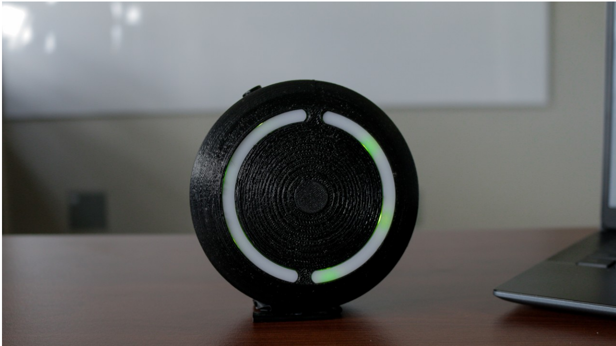
Dispositivo que mide el dióxido de carbono (CO 2 ) en espacios cerrados. Foto: Steven Moya/TEC.
