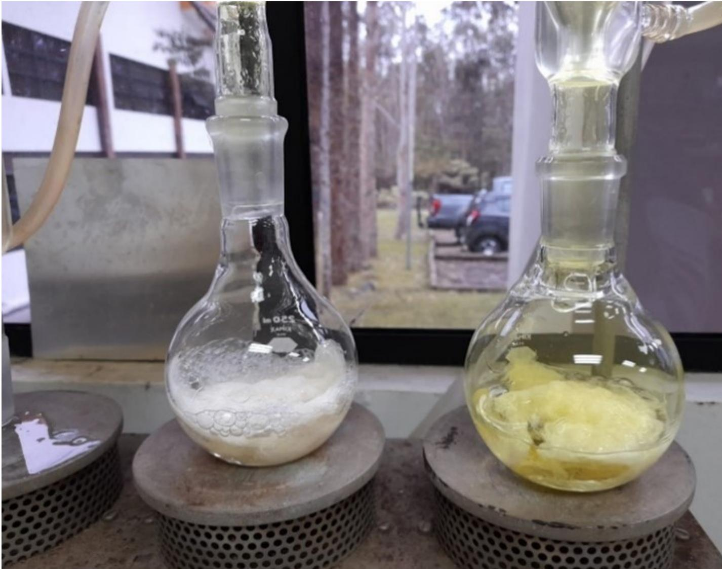
Las fibras vegetales son tratadas mediante un proceso químico y con temperatura para remover un componente llamado lignina. *Imagen cortesía de Dagoberto Arias.*
