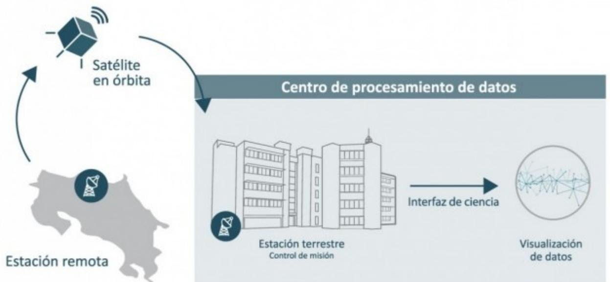
Uso de un **CubeSat 1U** para demostrar la capacidad de un sistema **Store and Forward** (almacenamiento y envío) para la **transmisión de datos ambientales**.
