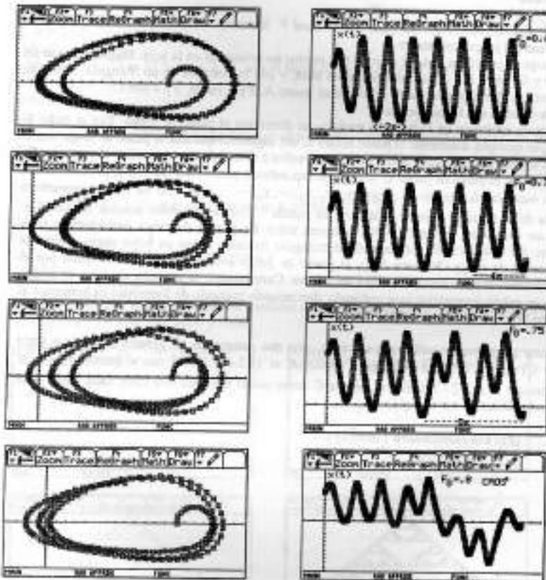
Las gráficas de la solución  $x=x(t)$  fueron dibujadas en el intervalo de tiempo  $[0, 16\pi]$ . Podemos notar que para  $F_0 = 0.6$ , la solución es periódica con periodo  $2\pi$ . Para  $F_0 = 0.7$  existe una duplicación del
