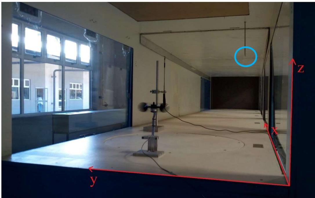
Figura 3: Detalle del sistema de coordenadas (rojo) y tubo de Pitot (celeste).
