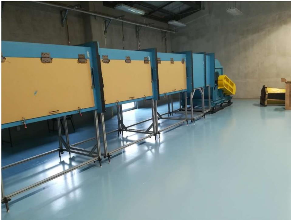
Figura 1: Túnel de viento.
