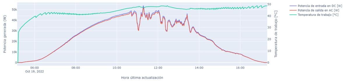
Figura 6.37: Comportamiento de la potencia y la temperatura durante el día 19 de octubre del año 2022.
