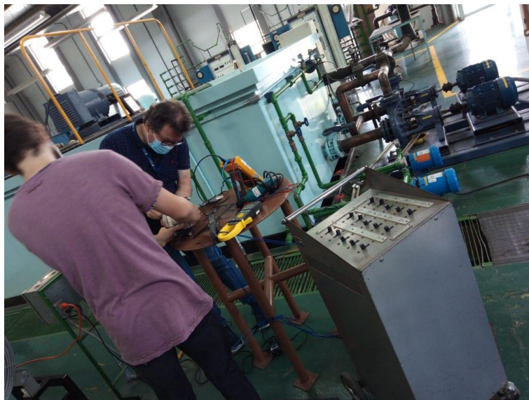
Figura 2. Pruebas con taladro al generador con el banco de resistencias (Caja gris a la derecha) como carga.
