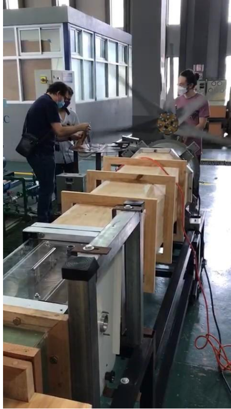
Figura 1. Prueba del generador con el túnel de viento.
