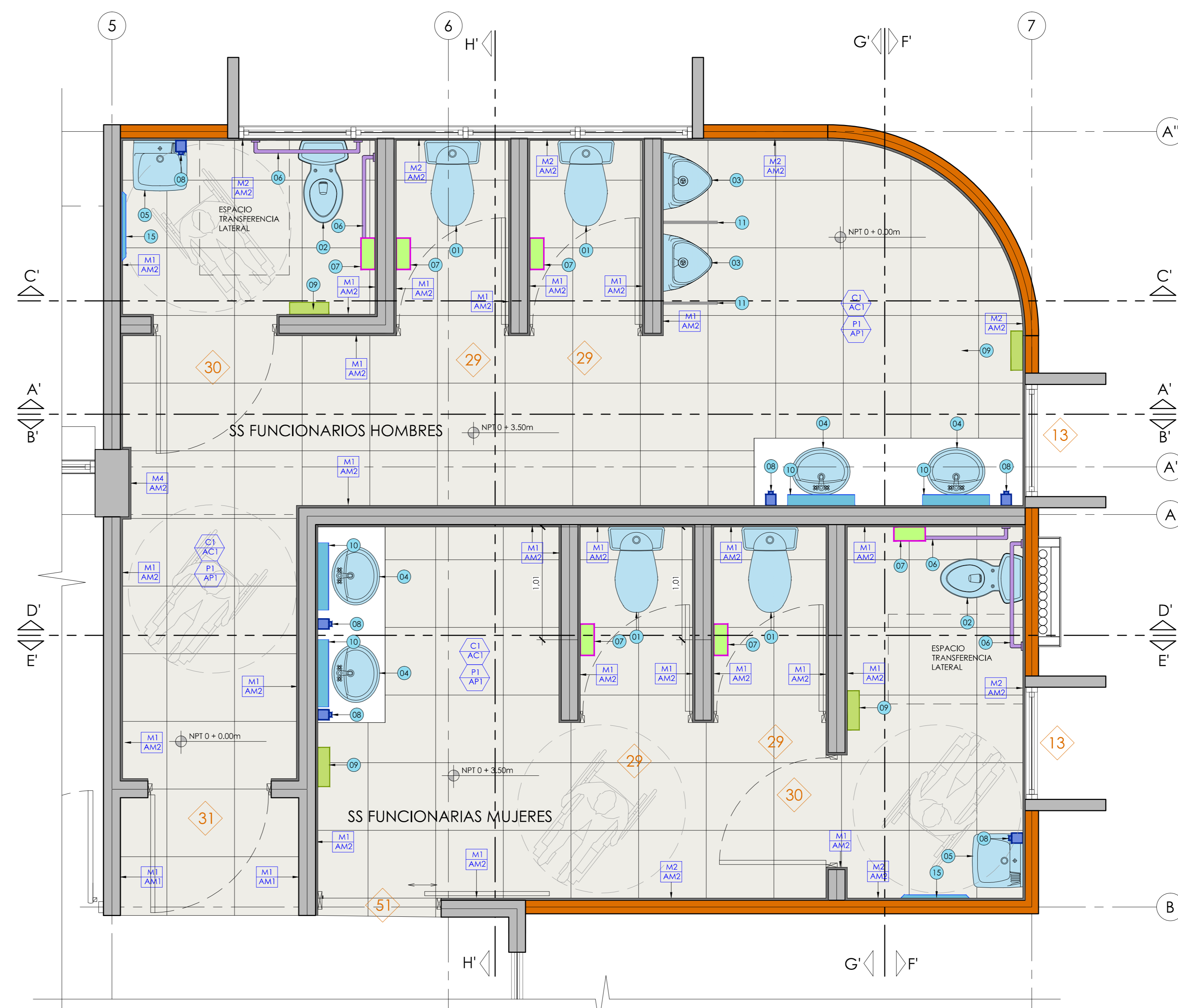
DETALLE AMPLIADO DE LA PLANTA DE BATERÍA SANITARIA TIPO 2 ESCALA 1:25
