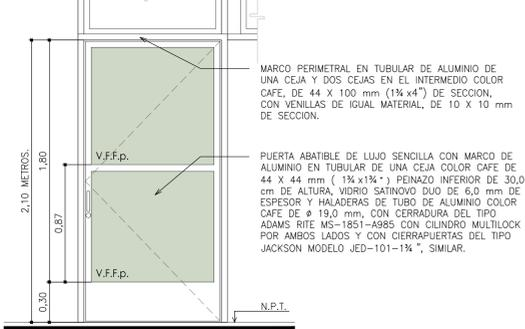
ELEVACION. PUERTA TIPO 4 DE ALUMINIO, APERTURA HACIA AFUERA, 90 GRADOS. ESCALA 1:20
