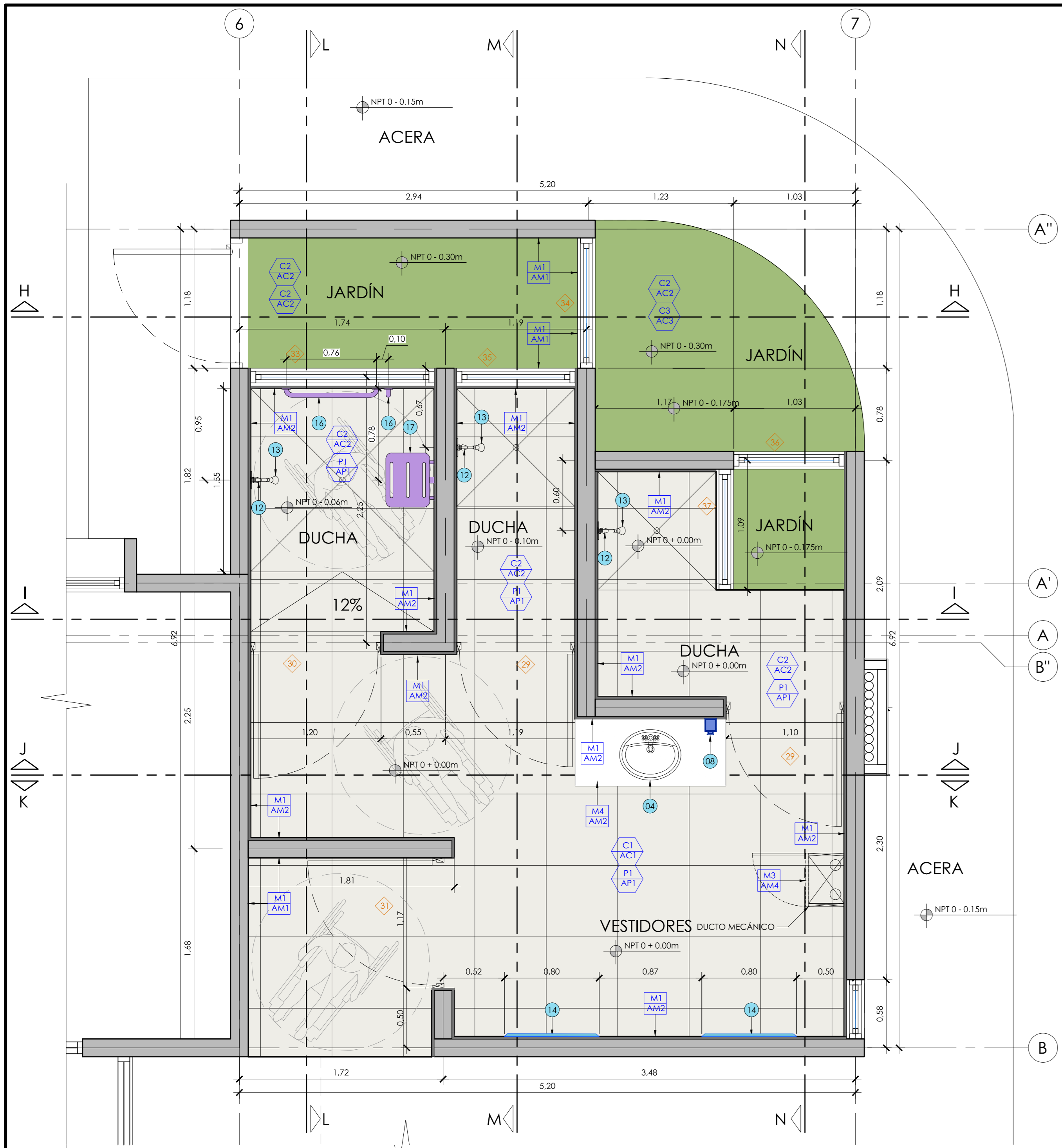
DETALLE AMPLIADO DE LA PLANTA DE LA BATERÍA DE DUCHAS ESCALA 1:25
