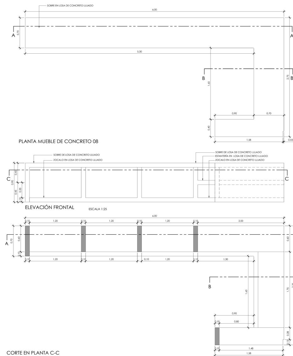
**DETALLE MUEBLE DE CONCRETO 08** ESCALA 1:20
