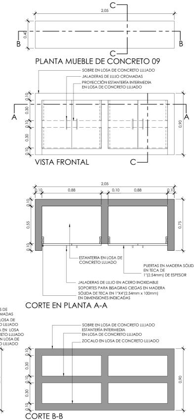
**DETALLE MUEBLE DE CONCRETO 09** ESCALA 1:20
