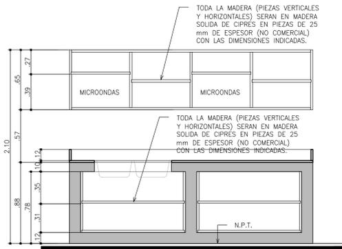
SECCION POR A-A ESCALA 1:20
