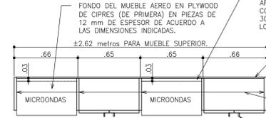
SECCION POR D-D ESCALA 1:20
