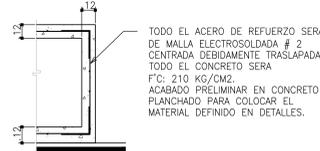
ELEVACION DETALLE DE REFUERZO. ESCALA 1:20
