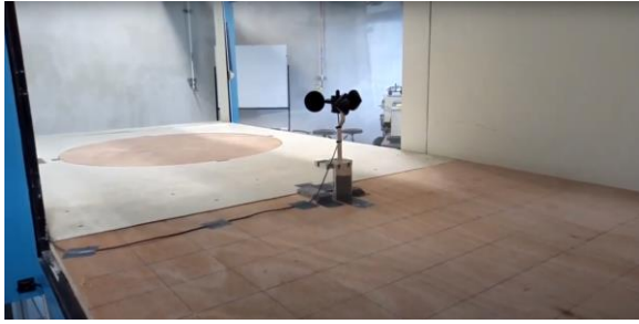
Figura 2. Anemómetro de copas montado en la sección de pruebas del túnel de viento.
