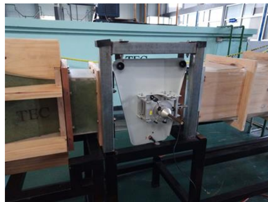
Figura 1. Balanza Tecquipment AF1300Z instalada en el túnel de viento
