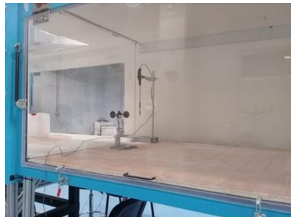
Figura 1. Montaje del anemómetro de copas.
