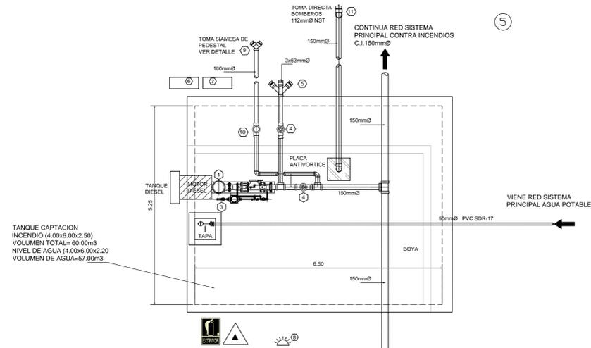
PLANTA INSTALACION MECANICA CUARTO MECANICO
