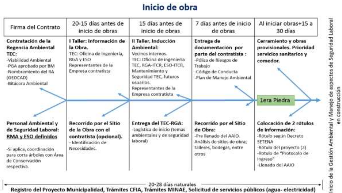
Fuente: Elaboración del Área de Salvaguarda Ambiental y Social Figura 9. Logística de inicio de obra para las iniciativas del PMI.
