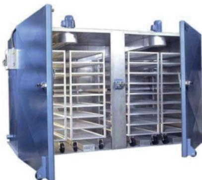
Figura 2. Secador industrial por convección.
