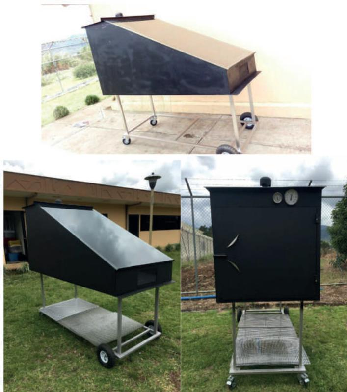
Figura 17 Vistas del prototipo de deshidratador solar construido como parte del proyecto.
