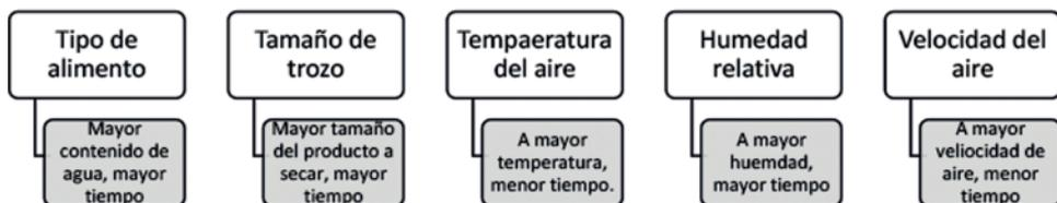
Figura 9. Factores que intervienen en el tiempo de secado solar.
