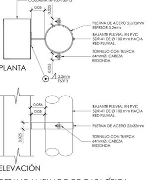
DETALLE AMPLIADO DE GAZA TÍPICA PARA SOPORTE DE BAJANTE
