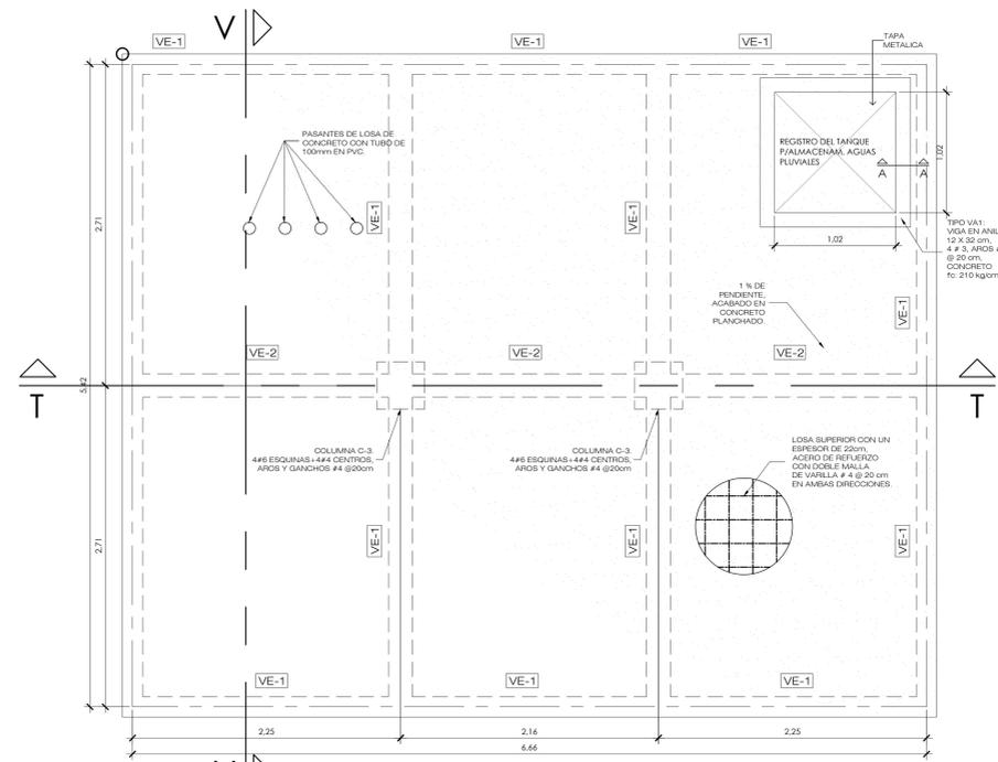
**PLANTA DE LA CUBIERTA DEL TANQUE DE AGUA**
