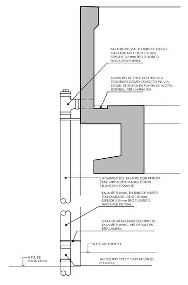
ELEVACION DE SECCION TRANSVERSAL. DETALLE TIPICO DEL BAJANTE PLUVIAL. ESCALA 1:15
