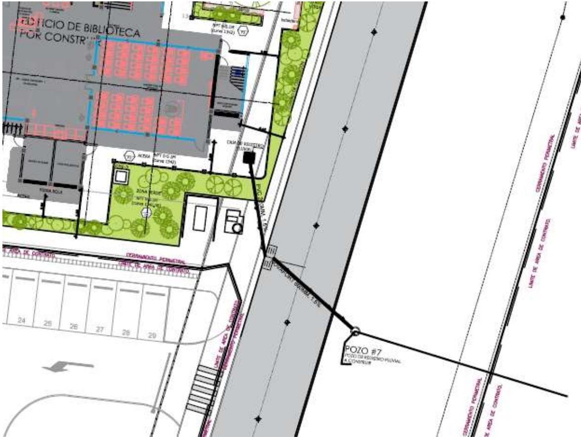
Figura 17. Acercamiento de la interconexión al alcantarillado Pluvial del ITCR.
