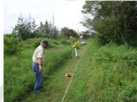
Fotografías: vistas de sondeo Wenner de resistividad en ejecución en el sector Este del terreno del proyecto.
