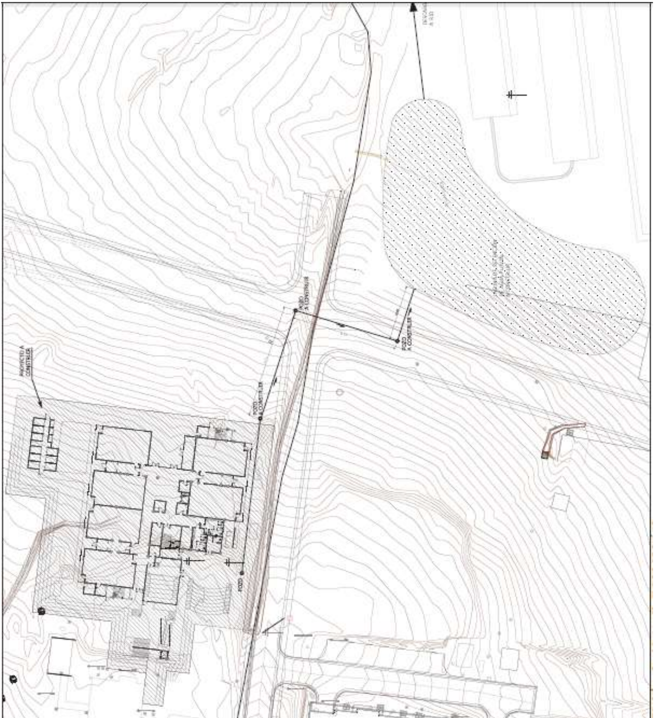
Figura 17. Interconexión al alcantarillado Pluvial del ITCR, incluyendo la Laguna de Retención.
