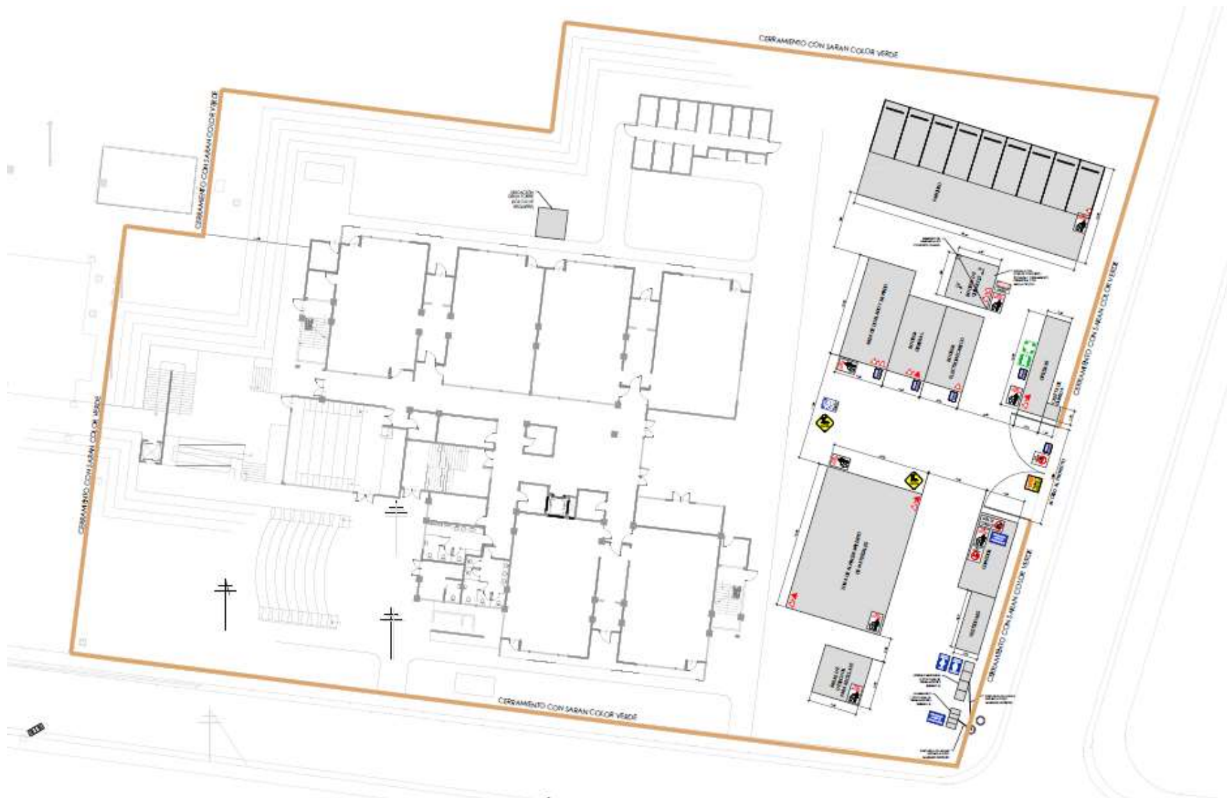
Figura 14. Esquema general de ubicación de obras provisionales y conexiones de redes mecánicas. Proyecto Núcleo Integrado de Química Ambiental. ITCR. 2015.
