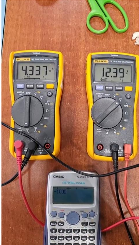
Figura 4: Montaje de los multímetros para la toma de los videos, la calculadora servía para especificar las revoluciones del motor para cada video
