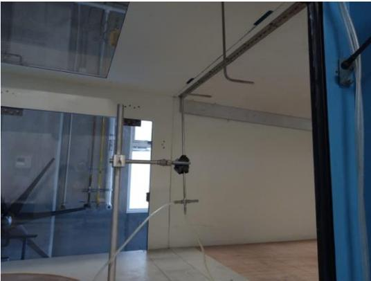
Fig. 4 Pitot Perfect Prime en el túnel de viento.
