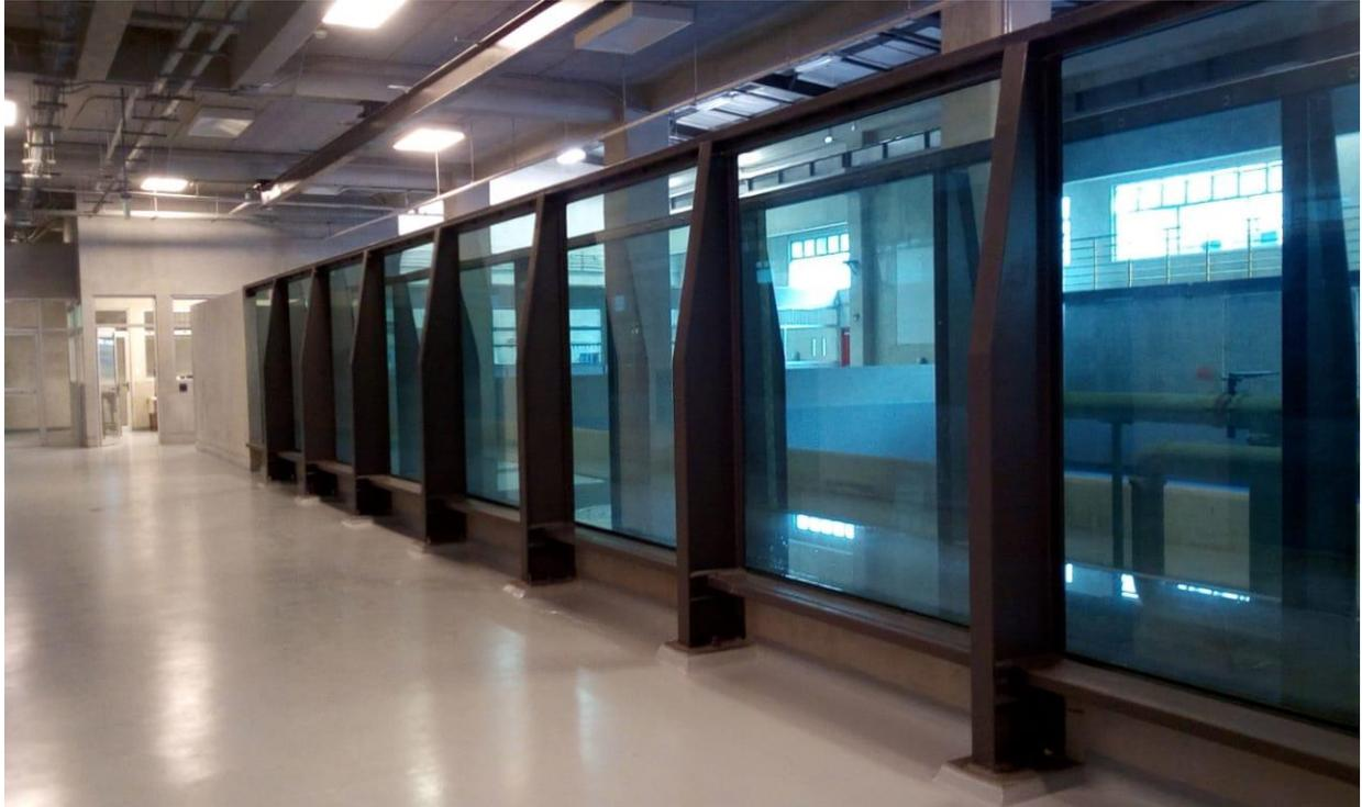
El nuevo edificio del INII cuenta con un canal y un tanque de oleaje, el cual permite el estudio del efecto de las olas sobre estructuras. Este se encuentra en proceso de construcción y se espera que en un periodo de tres meses se encuentre operativo. Este equipo se encuentra a cargo de la Unidad de Ingeniería Marítima de Ríos y Estuarios (IMARES).
