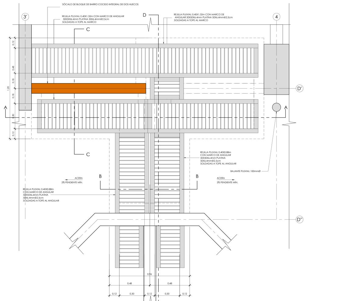
PLANTA REJILLAS DE TUBERÍA DE GASES ESCALA 1:10
