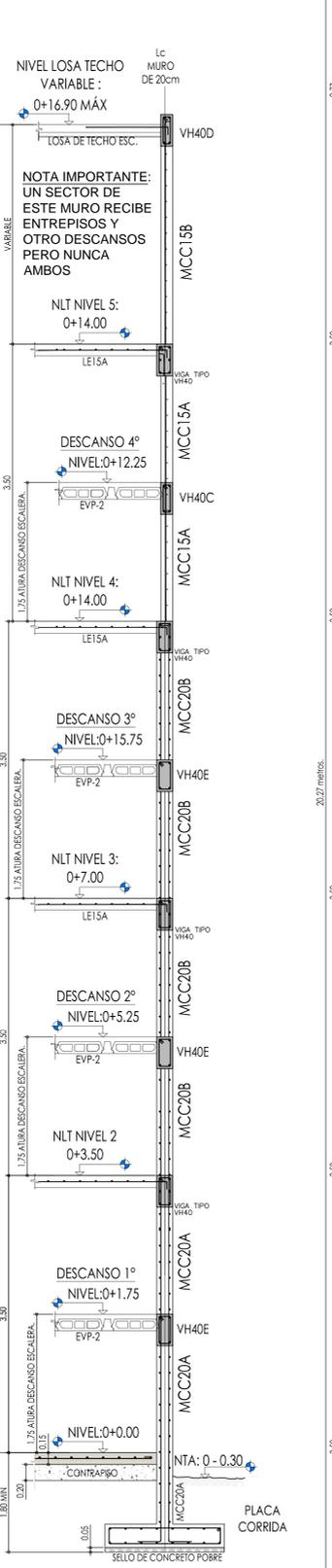
SECCION TIPICA MURO
