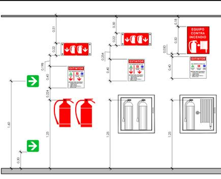
DETALLE DE ALTURA DE LAS SEÑALES Y LOS EXTINTORES
