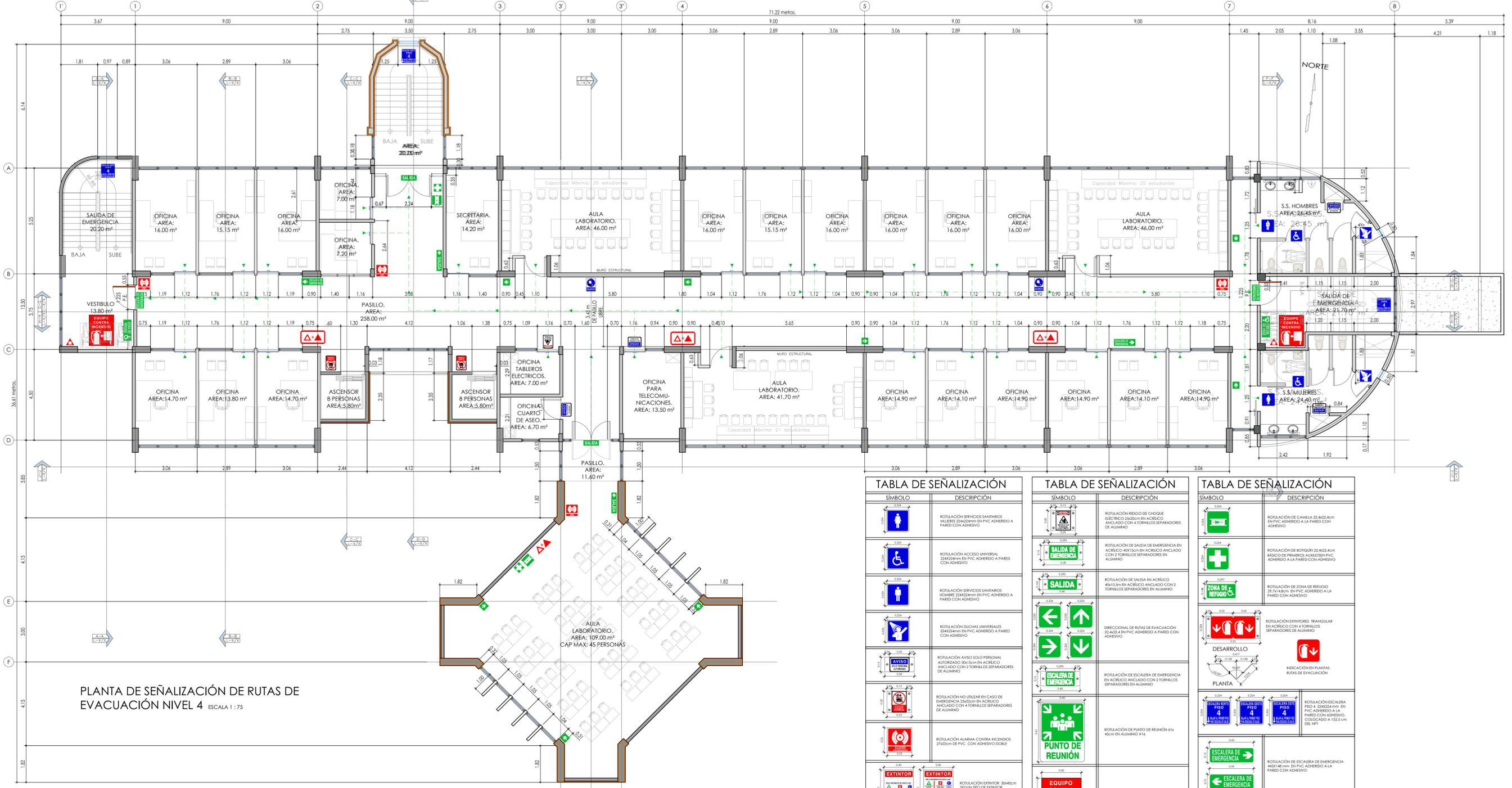
PLANTA DE SEÑALIZACIÓN DE RUTAS DE EVACUACIÓN NIVEL 4 ESCALA 1:75
