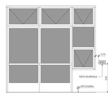
Nota: En las puertas de doble hoja deberán colocarse del lado del herraje de accionamiento, en una zona comprendida entre 1.45m (+/-0.15m) a una distancia máxima de 0.10m del borde del contramarco. En caso de no haber el espacio necesario se deberá colocar el rotulo sobre la puerta.
